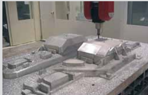
Fresatura stampo automobilistico. Materiale: Alluminio
