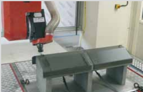
Fresatura particolare aeronautico. Materiale: fibra di carbonio
