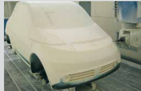
Fresatura modello auto. Materiale: Resina
