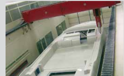
Fresatura coperta yacht di 22 mt Materiale: Vetro resina
